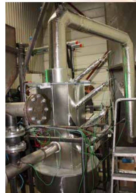
3b) Anlæg på Universitet i Sørøst-Norge, som kan lave gas til syntese af flydende biobrændstof.
