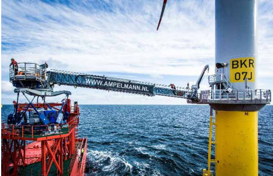
Figur 2a). Stewart-plattform plassert på skip med gangbane over til bunnfast installasjon eller vindmølle gir risikofri overgang for personell. Pressemateriale fra ampelmann.nl.
