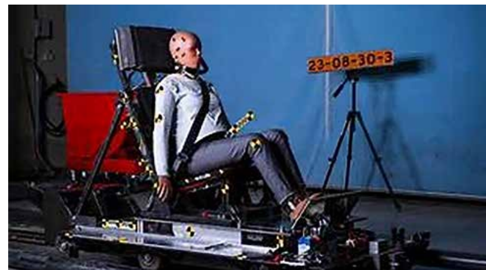
Figur 5b). Nyere slede med den første test-robot som spesifikt simulerer en kvinnelig bilfører utstyrt med sensorer. Fotograf Jonathan Nackstrand / AFP
