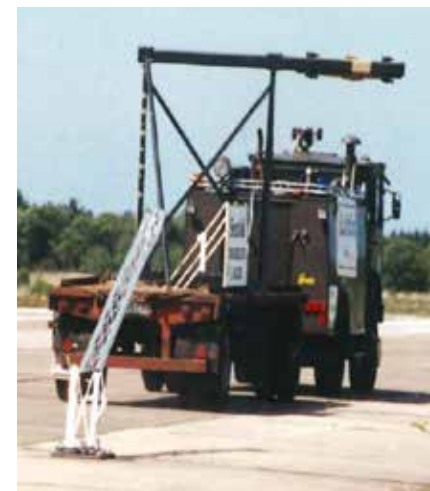
Figur 8. Test av ettergivende innflyvningslysmast. a) testoppsett med vingeseksjonen montert på tilhengeren 4 meter over bakken, b) skade på vingeseksjonen etter krasj med masten i a) [2].
