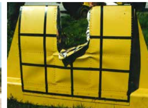
Figur 8. Test av ettergivende innflyvningslysmast. a) testoppsett med vingeseksjonen montert på tilhengeren 4 meter over bakken, b) skade på vingeseksjonen etter krasj med masten i a) [2].
