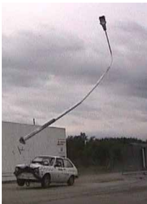
Figur 9, Testing av mast, a) testoppsett, for å oppnå korrekt hastighet på testkjøretøyet ble det benyttet et taljesystem, og kjøretøyet og retningen ble styrt ved bruk av en «rørgate» på hver side av testkjøretøyet. b) Ikke-energiabsorberende lysmast etter kollisjon i høy hastighet. [8]
