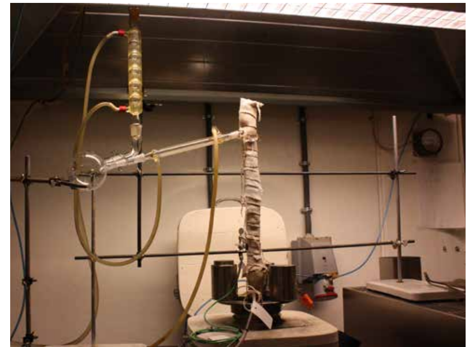
Figur 5. Pyrolyseanlæg hvor træ uden luft ved 500-1300°C bliver til trækul og gas, som kondenseres til trætjære i glastrørene. Nederst ses toppen af ovnen, hvor træet varmes op i nitrogenatmosfære. Fra ovnen stiger gassen op i et opvarmet glastrør før den nedkøles først i det skrå og derpå det lodrette glastrør. Kondensen eller rettere sagt trætjæren opsamles i glaskuglen til venstre.
