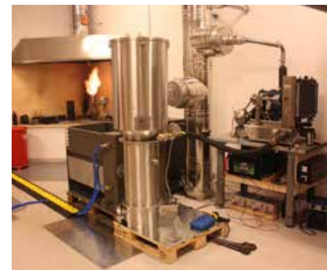
3a) Anlæg på Universitet i Agder til træflis med gasmotor og 5 kW elproduktion.
