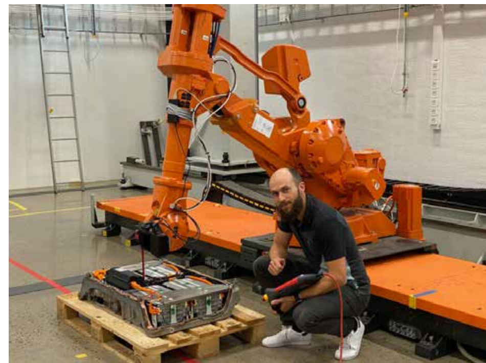
Figur 1. Automatisert demontering og sortering av bilbatterier i ulike metaller, i plast og kretskort, osv. Foto viser demontering av VW Passat hybrid batteripakke på UiA Grimstad. Foto UiA.
